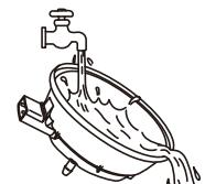
※汚れが取りにくいときは、プレートをガードから外し、差込口や裏面ヒーター部に水が入らないように、差込口を上にして流し洗いしてください。洗った後は、十分に乾燥させてください。
