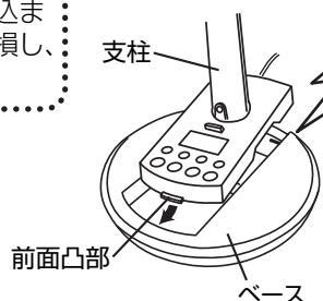
支柱後部のフックをベース後部のフック穴に合うようにはめ込みます。
