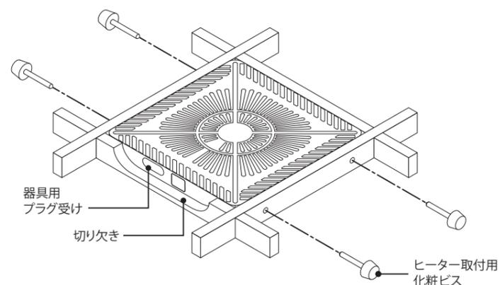
**2** 幅 29cm × 奥行き 33cm 取付けネジ間隔 20cm の場合
