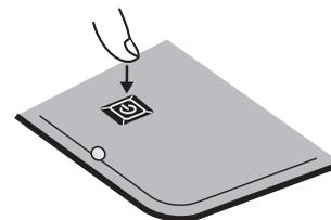
※電源投入後、2時間経過すると自動的に運転が停止します。(2時間自動OFFタイマー)
