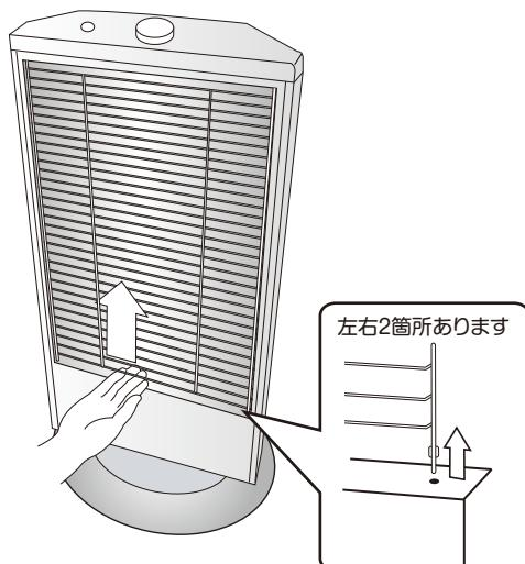
②ガード下部を手前に引出し、下方向にガードを引き抜きます。
