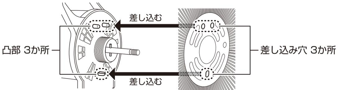
モーター部前面の凸部3か所に、後ガードの差し込み穴3か所を合わせて差し込みます。
