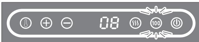
沸騰ボタンが点滅し、水温を表示します。(上図は水温が8°Cの場合)
