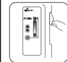
温度調節つまみを「強」の位置に合わせて、約3時間通電します。
