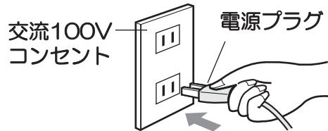
コンセントに電源プラグを差し込み、温度調節つまみを「強」に合わせる
