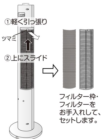
フィルター枠のツマミを軽く引っ張り、上にスライドさせて外します。
