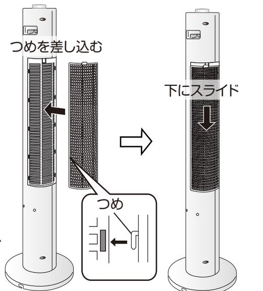
①フィルター枠の両側のつめを本体の穴に差し込みます。(10カ所)
