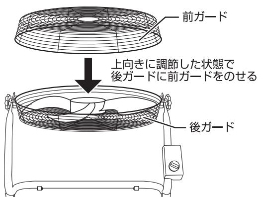
ガード固定ネジを右に回して固定する
