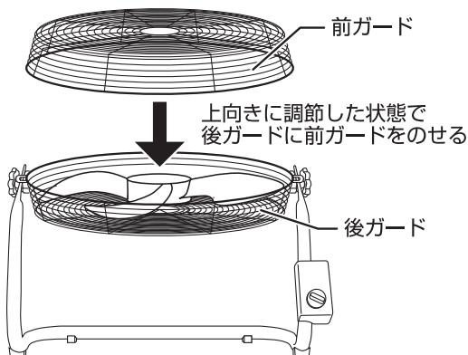
ガード固定ネジを右に回して固定する
