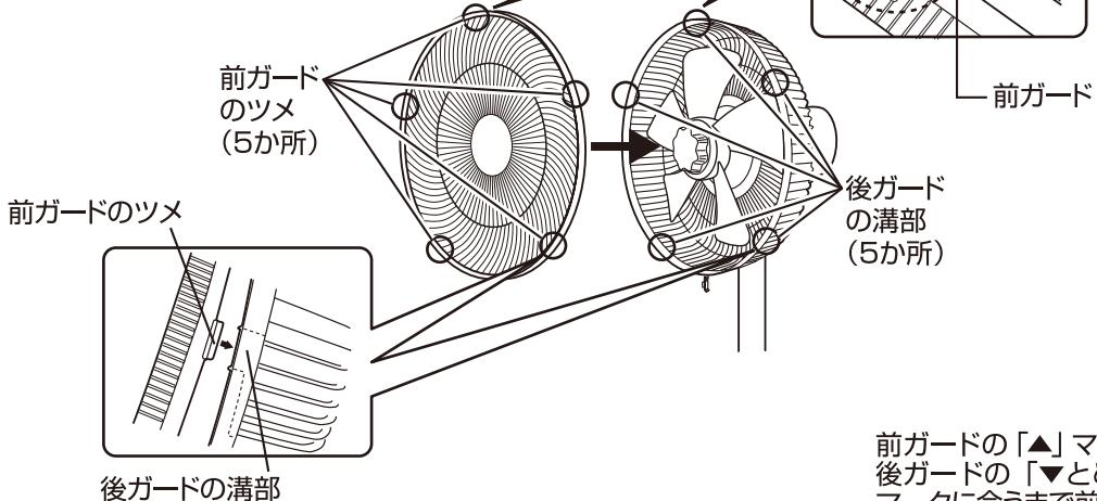
③ 前ガードの「▲」マークが後ガードの「▼とめる」マークに合うまで前ガードを時計回りに回してください。
