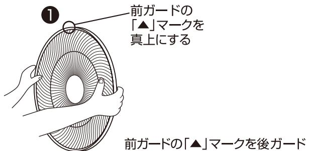
前ガードの「▲」マークを後ガードの「はずす▼」マークに合わせて差し込む
