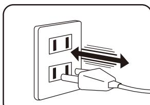
短寿命 電源プラグを斜めに抜き差しする
