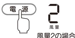
電源ランプと風量が表示されて、運転が始まります。もう1度押すと、停止して表示が消えます。
