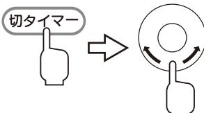
電源ボタンを押して運転させて、切タイマーボタンを押してからダイヤルを回し、時間を設定します。
