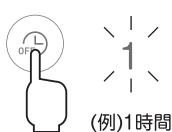
電源ボタンを押して運転させて、切タイマーボタンを押すとセットされ、押すたびに設定時間がかわります。設定時間に応じたランプが点灯します。設定時間が経過すると、運転が停止します。
