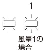
電源ランプと風量ランプが点灯して、運転が始まります。もう1度押すと停止して、電源ランプと風量ランプが消灯します。
