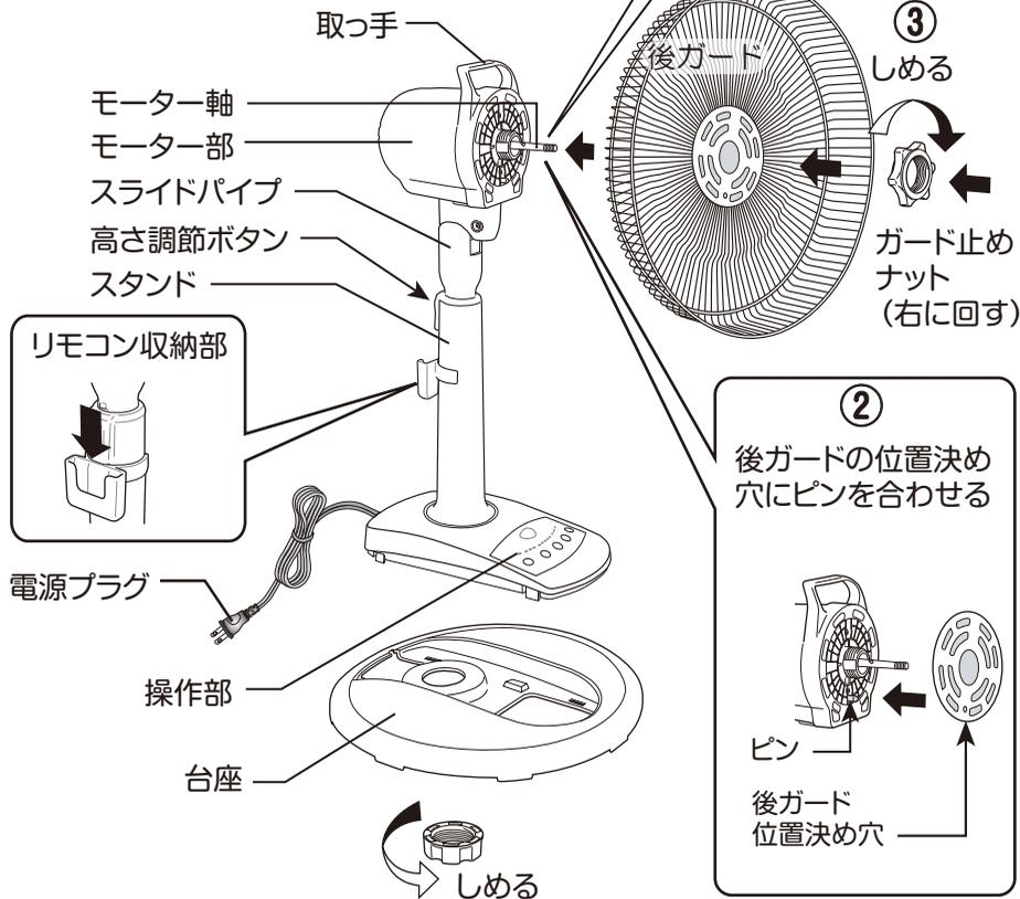
① 電源コードを台座の穴に通し、スタンドのツメ4箇所を台座の穴に差し込む
