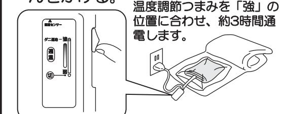
温度調節つまみを「強」の位置に合わせ、約3時間通電します。
