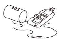
2 コントローラーを接続する凸部と凹部を合わせる
