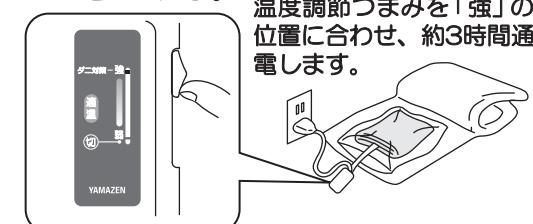
温度調節つまみを「強」の位置に合わせ、約3時間通電します。
