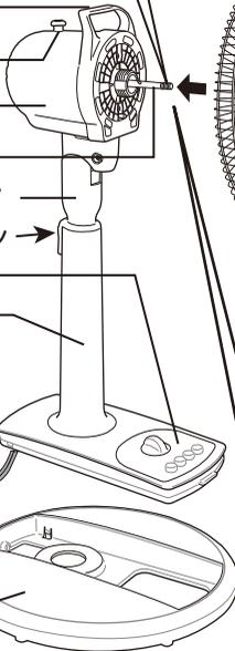
組立て前にモーター軸からナットと保護キャップ、スピナーを外してください。 ※注意:スピナーは逆ネジになっています。
