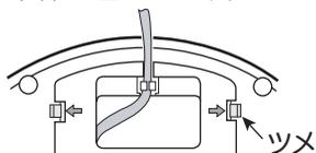
台座固定ナットを外してから台座のツメ(2ヶ所)を矢印方向に押し本体を上引っ張ってください。
