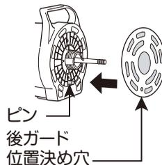
⑥ 後ガードの印に合わせて前ガードのツメを掛ける
