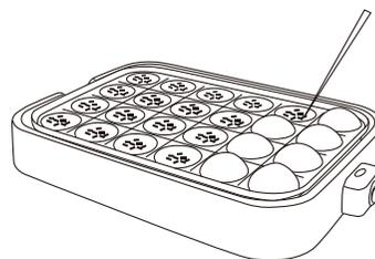
■ヒーターの構造上、比較的早く焼ける穴と遅く焼ける穴があります。たこ焼きを上手に仕上げるコツとして、焼き上がったものからお皿に取り上げ、竹串などで順番に早く焼ける穴へ移していくと上手に焼くことができます。
