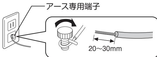
アース線先端を20~30mm程度剥き、アース端子に確実に固定してください。
