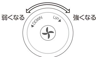
ダイヤルを回すことによって風量が5段階に変わり、風量に対応して数字(1~5)を表示します。
