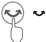
左右首振りボタンに触れると、送風口が首振り動作して左右首振りマークが点灯します。再度触ると停止します。
