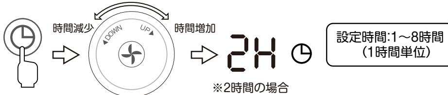
運転中に切タイマーボタンに触れてから、約5秒以内にダイヤルを回して時間を設定します。表示部に時間が表示され、設定が完了すると室温表示にかわります。(切タイマーマークが点灯します。)
