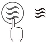
リズムボタンに触れると、風量をランダムに変化させるリズム運転になり、リズムマークが点灯します。再度触ると通常の風に戻ります。
