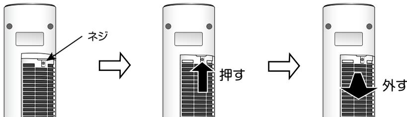
①フィルター枠上部のネジ1本をプラスドライバーで外します。
