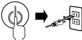
ご使用後は、電源ボタンに触れて、電源を切り、電源プラグをコンセントから抜いてください。
