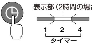
運転中にタイマーボタンに触ると、切タイマーがセットされます。触れたたびに設定時間がかわります。
