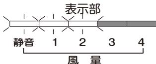
電源ボタンに触ると運転を始め風量ランプが点灯します。
