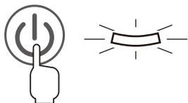
電源ボタンに触れると運転を始め風量ランプが点灯します。
