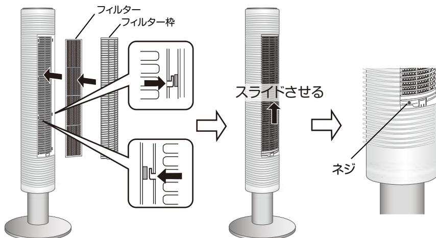
①フィルター枠の両側の凸部を本体の穴に差し込みます。(8カ所)
