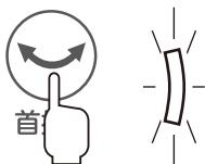
左右首振りボタンに触れると本体が首振り動作します。このとき首振りランプが点灯します。
