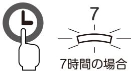
運転中に入タイマーボタンを押すとセットされ、押すごとに設定時間がかわります。設定時間に対応したランプが約5秒間点滅して点灯に変わると設定が完了し運転が停止します。設定時間が経過すると運転を開始します。
