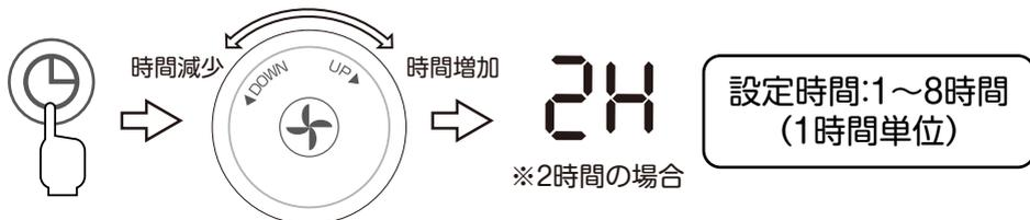
運転中に切タイマーボタンに触れてから、約5秒以内にダイヤルを回して時間を設定します。表示部に時間が表示され、設定が完了すると室温表示にかわります。
