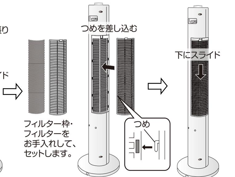
①フィルター枠の両側のつめを本体の穴に差し込みます。(10カ所)
