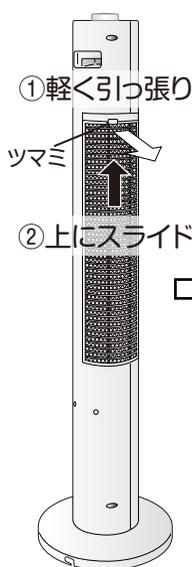
フィルター枠のツマミを軽く引っ張り、上にスライドさせて外します。
