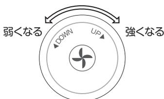
ダイヤルを回すことで風量が8段階にかわり、風量に対応して数字(1~8)を表示します。
