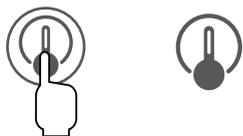
センサー運転ボタンに触れると、温度センサーで感知した室温に応じて、自動的に風量を変えて運転します。このときセンサーボタンが点灯して、表示部に緑色のセンサーマークが表示されます。
