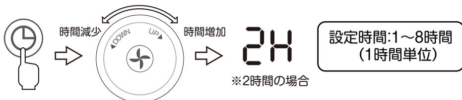
運転中に切タイマーボタンに触れてから、約5秒以内にダイヤルを回して時間を設定します。
