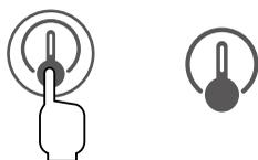
センサー運転ボタンに触れると、温度センサーで感知した室温に応じて、自動的に風量を変えて運転します。このときセンサーボタンが点灯して、表示部にセンサーマークが表示されます。
