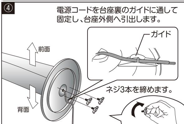
組立て後、本体を水平な場所に立てて、台座が確実に固定されていることを確認します。
