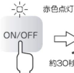
電源ボタンを押すと電源ランプが赤色点灯になり、約30秒間送風運転をしてから停止します。その後、電源プラグをコンセントから抜いてください
