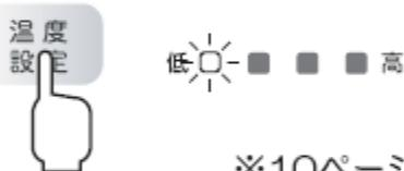
温度設定ボタンを押すと「低」に切り換り、1度押すたびに、1段階ずつ高くなっています。「高」のとき、ボタンを押すとランプが消灯して温度設定を解除し、温度に関係なく連続運転します。
