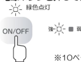
電源ボタンを押すと電源ランプが緑色点灯になり「強弱切換→強」で運転を始め、「強」のランプが点灯します。
