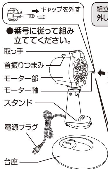
組立て前にモーター軸からナットと保護キャップ、スピナーを外してください。※注意:スピナーは逆ネジになっています。
