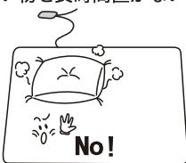
部分的に保温した状態で長時間使用されると、ヒーター線の経年劣化が加速します。部分的に温度が高くなり、ヒーター線を傷めて発火したり、異常動作をしたりしてやけどをするおそれがあります。
