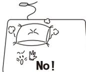
部分的に保温した状態で長時間使用されますと、ヒーター線の経年劣化が加速します。部分的に温度が高くなり、ヒーター線を傷めて発火したり、異常動作をしたりしてやけどをするおそれがあります。
