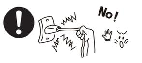
コードを引っ張ると、コードが破損して、感電・ショート・火災の原因となります。
