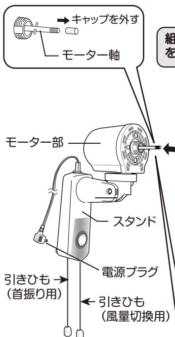
組立て前にモーター軸からナットと保護キャップ、スピナーを外してください。※注意:スピナーは逆ネジになっています。
