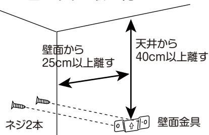
壁面に壁面金具をネジでしっかりと固定してください。
