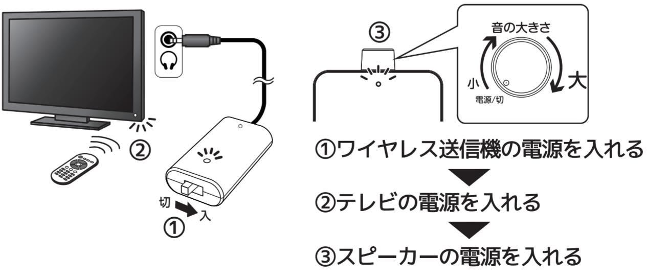
ご使用後はスピーカーの電源を切り、ワイヤレス送信機の電源を切ります。
