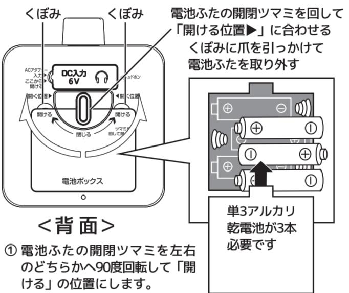
① 電池ふたの開閉ツマミを左右のどちらかへ90度回転して「開ける」位置にします。
