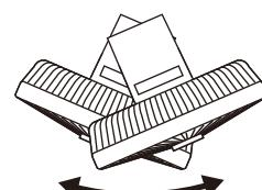
※首振り機構は、専用モーターと、その他連結部分で構成されています。
