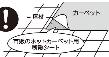
断熱をしないと、床材の変色・変形・割れ・すき間の原因になります。
