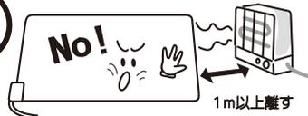
熱でコントローラーおよび本体が変形し、故障や事故の原因になります。
