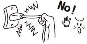
コードを引っ張ると、コードが破損し、感電・ショート・火災の原因になります。
