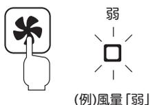
風量ボタンを押すたびに風の強弱が変わり、風量ランプが点灯します。
