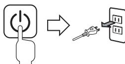
電源ボタンを押して電源を切ってから、電源プラグをコンセントから抜いてください。
