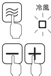
モードボタンを押して「冷風」を選んでください。冷風ランプが点灯し冷風を送り出します。
