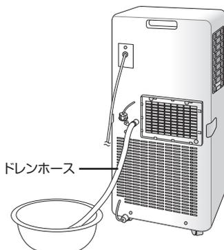
③ドレンホース接続口に付属のドレンホースを取り付けてください。ドレンホースはキャップがついている方を排水口に取り付けてください。
