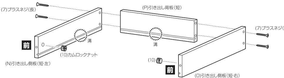
② 引き出し前板(短)にカムロックボルトを取り付けます。
