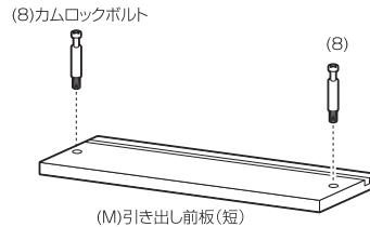
③ 引き出し底板(短)を差し込み、引き出し前板(短)を取り付けます。
