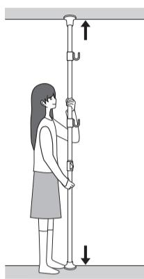
① 設置場所にて、片手で下部パイプを、もう片方の手で上部パイプをしっかりと持ちます。床と垂直になるように立ててください。(左図参照)
