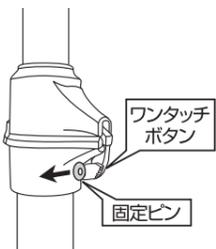
固定ピンを矢印の方向に外して、ワンタッチボタンを押すと、上部パイプが伸縮自在になります。
