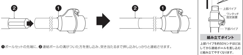
① ポールセットの先端に、② 連結ポールの溝がついた方を差し込み、突き当たるまで押し込みしっかりと連結させます。
