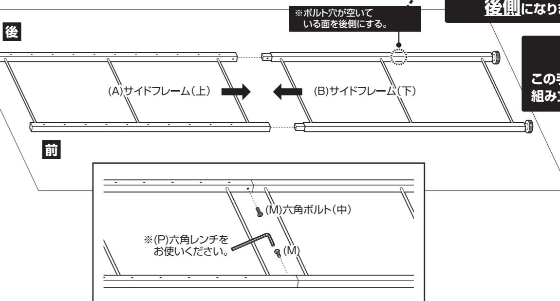
2 組み立てたサイドフレームにパイプを取り付けます。
