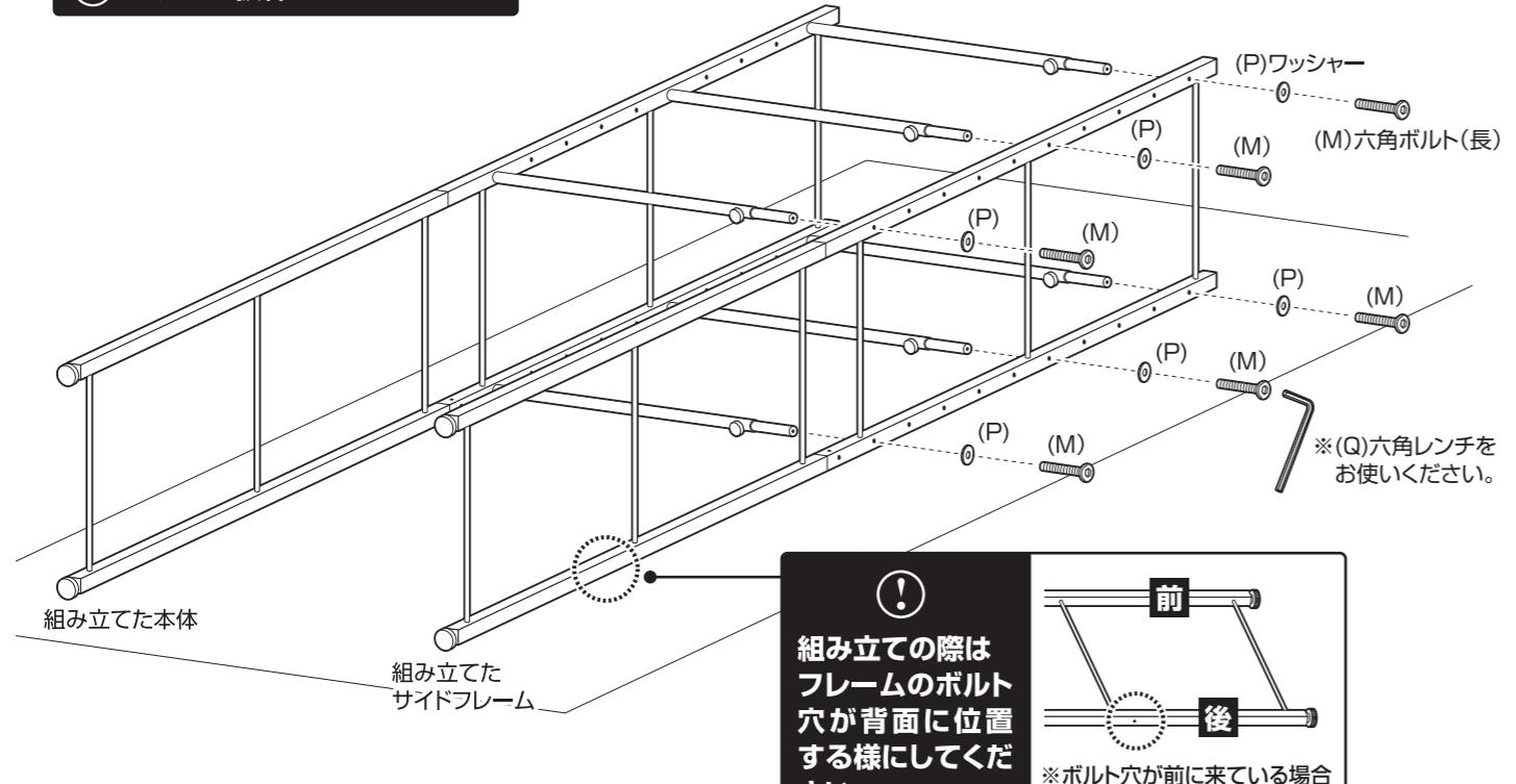
**4** 組み立てた本体を起こし、背面に補強バー用パイプを取り付けます。
