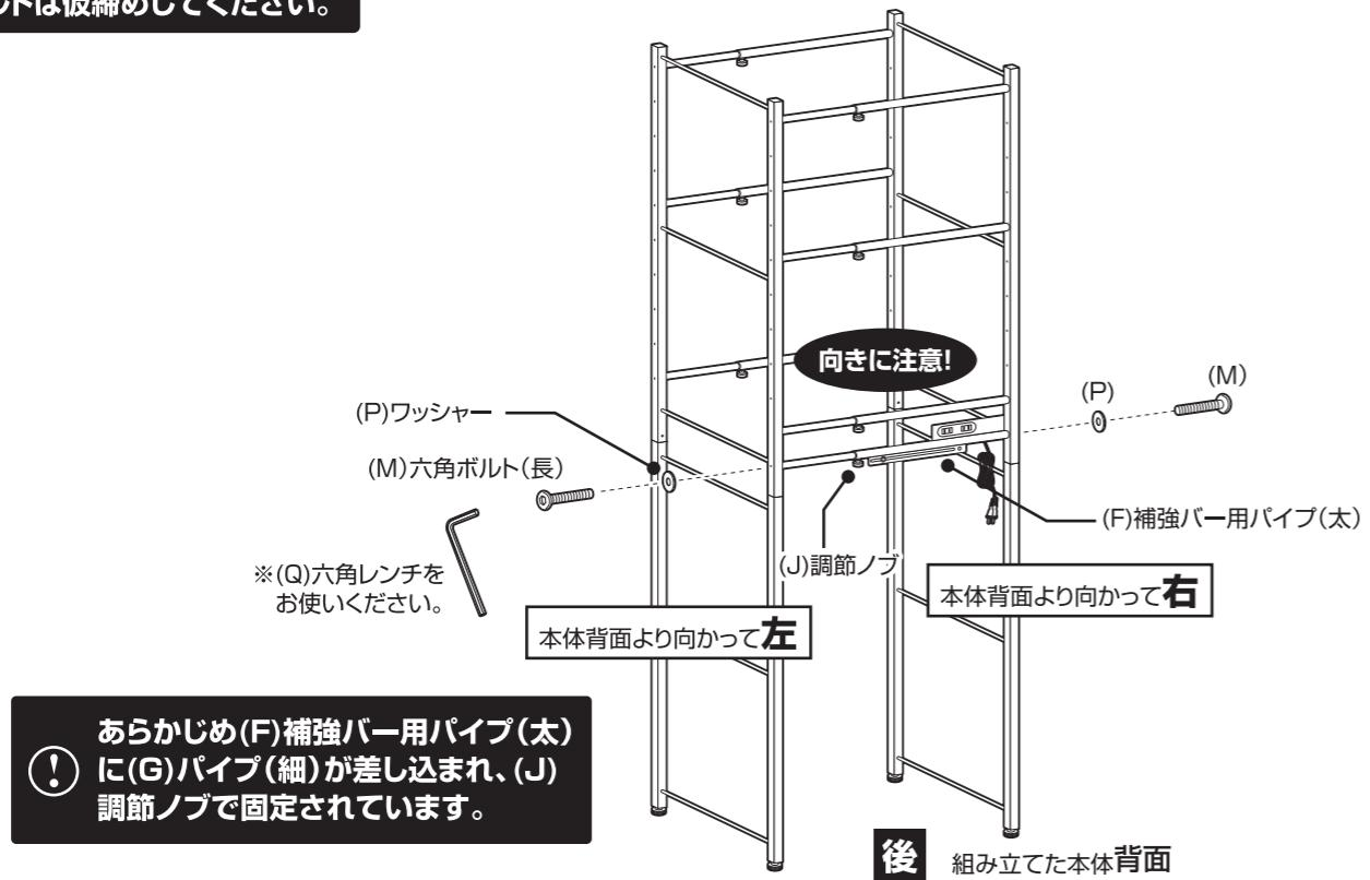
**5** 組み立てた本体背面に補強バーを取り付けます。
