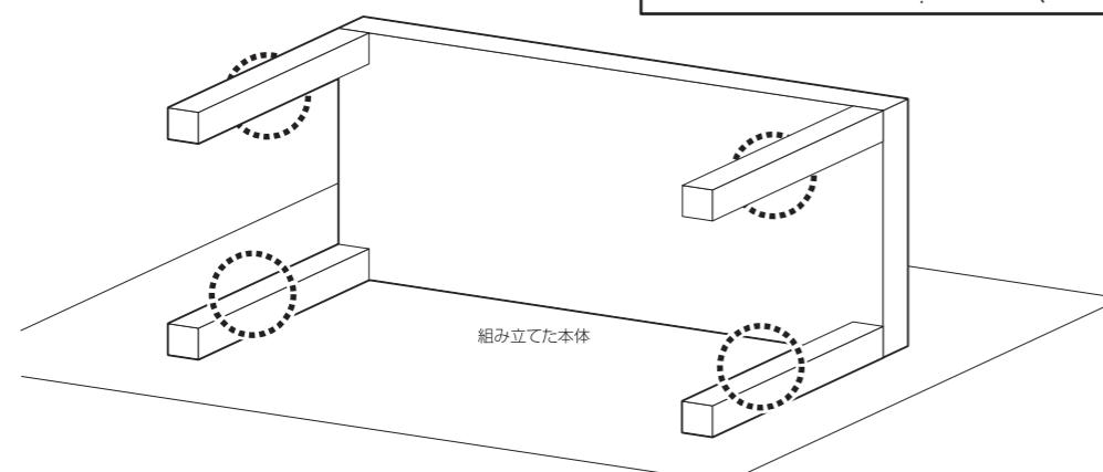
**4 組み立てた本体に、棚板とフェルトを取り付けます。**
