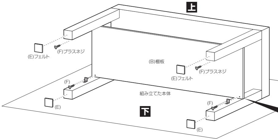
**3 組み立てた本体に固定金具を取り付けます。**
