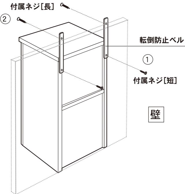
柱・鴨居等のしっかりした木部に付属のネジを使って締め付けてください。
